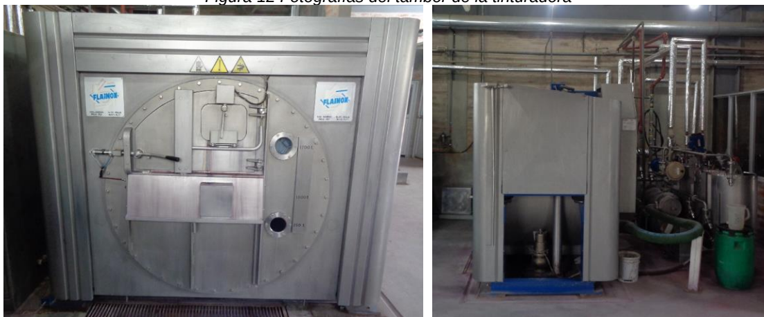
Figura 12 Fotografías del tambor de la tinturadora
