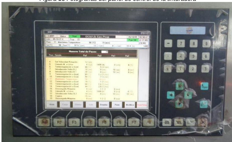
Figura 13 Fotografías del panel de control de la tinturadora
